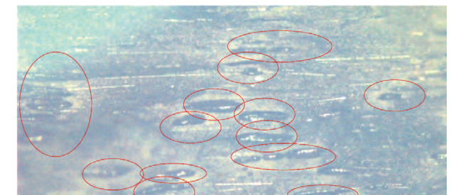
劣质隔热条有少量玻璃纤维，存在大量的气泡
