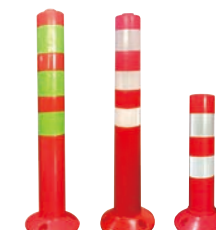
名称: 柔性柱 型号: TLJT-RXZ01 规格: \phi 89 \times 450 \text{mm} \phi 89 \times 750 \text{mm} 材料: PVC加反光晶格 适用: 道路分叉口警示、隔离用
